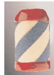
Typ PU-AC PU-Schaum mit Streifen aus abriebfestem Polyurethan und einer Carborundum-Schicht Rotierende Bewegung Gleichmäßige Entfernen von Ablagerungen, und Korrosion
